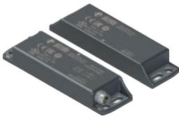
Los sensores magnéticos codificados son dispositivos adaptados al control de protecciones y resguardos de las máquinas sin inercia. Conectados con el módulo de seguridad correspondiente pueden crear un sistema de categoría de seguridad hasta SIL 3 según EN 62061, hasta PL e según EN ISO 13849-1 y hasta categoría 4 según EN ISO 13849-1.
